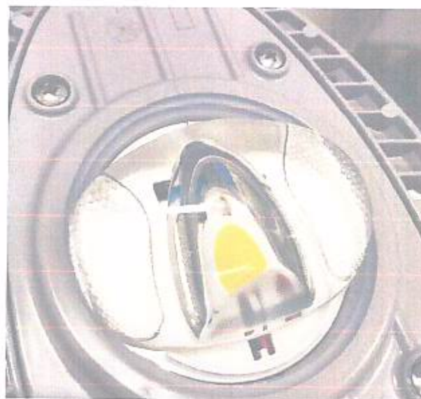
Foto 8 - Após ensaio de IK.
